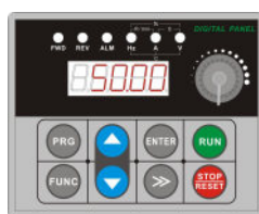
Рисунок 3-2 Остановка Заданная частота "50.00"
