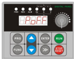
Рисунок 3-1 Отображение параметров при включении питания Отображение инициализации "P.OFF"
