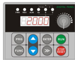
Рисунок 3-3 В рабочем состоянии отображение текущей выходной частоты "20.00"
