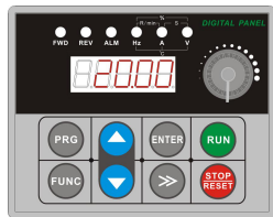
Fig 3-3 Run Status Parameter Display Display Current Output Frequency "20.00"
